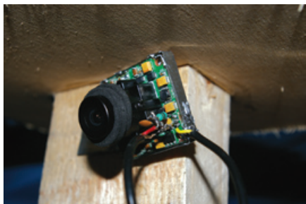
经过电路修改的，无辐射，无干扰的摄像头。
