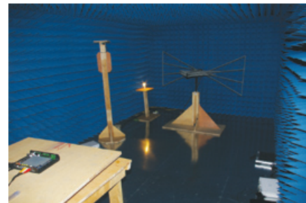
内部净空尺寸长4.8米，宽2.5米，高1.8米，基本满足准3米法测试要求。转台、摄像头架、灯架、天线架全部为自制无辐射木制品。
