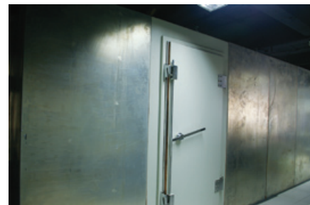
实验室外部。设计特点：工作频率30MHz至3GHz。外壳采用通用屏蔽室改造的方法，通用屏蔽室为长5.6米，宽3.4米，高2.35米。
