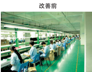
装配现场无空调，地面不防静电，纸箱随意放
