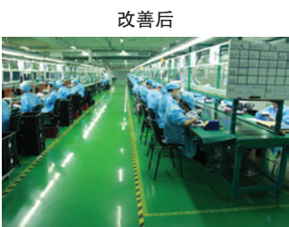
装配地面改善为防静电地面，有中央空调，现场均有定位、标识
